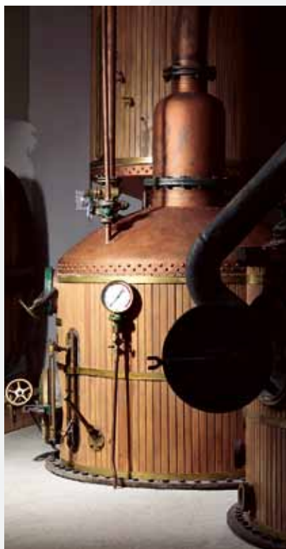
Brännvinsapparaterna användes för destillation vid Reimersholms spritfabrik.
